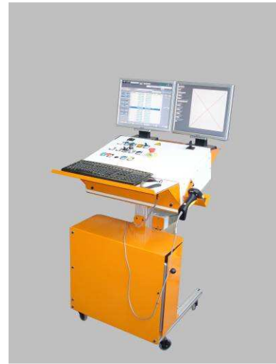
Pupitre de commande intégrant l'ensemble des boutons, un micro ordinateur, 2 écrans vidéo, un lecteur codes barres.
