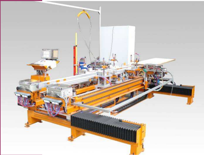
Vue d'ensemble de la cadreuse à plat. Elle comporte 7 axes numériques (réglages dimensionnels + vissage). L'évacuation des menuiseries est automatique.
