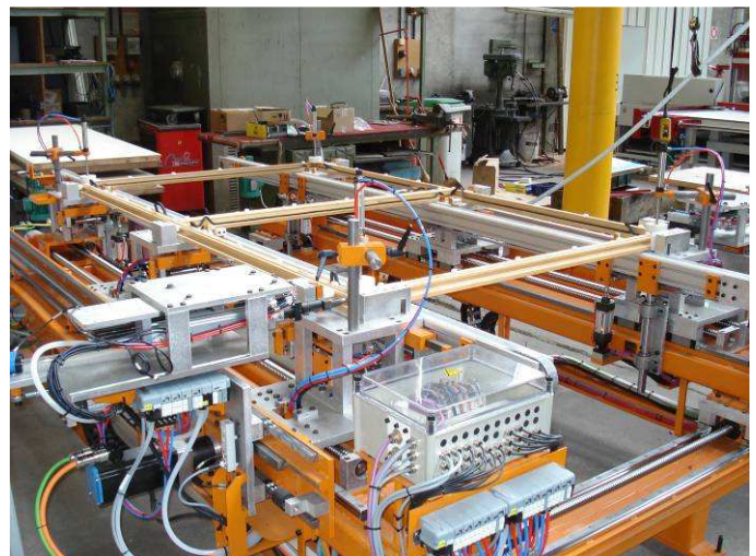
Exemple de cadrage d'un grand cadre (2500 x 1500 mm) avec traverse intermédiaire.
