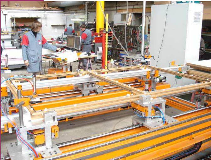
Cadre en cours de cadrage. La machine permet de positionner et visser 2 montants + 2 traverses + une traverse intermédiaire. Le couple de serrage est réglable numériquement.
