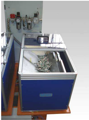
Vue d'un des 2 bols de distribution des vis. Longueur des vis distribuées et soufflées : 130 mm.
