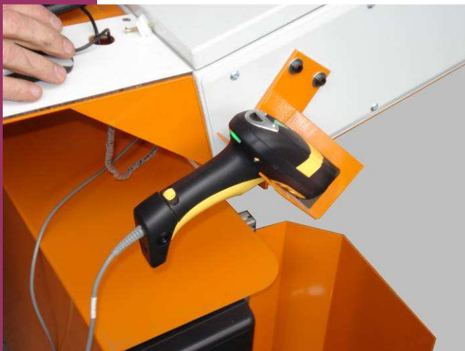
Vue de la douchette de codes à barres. Ce dispositif évite toute erreur de saisie de l'opérateur au moment de lancer le programme.
