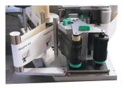
Système d'impression par transfert thermique intégré, géré par ordinateur.
