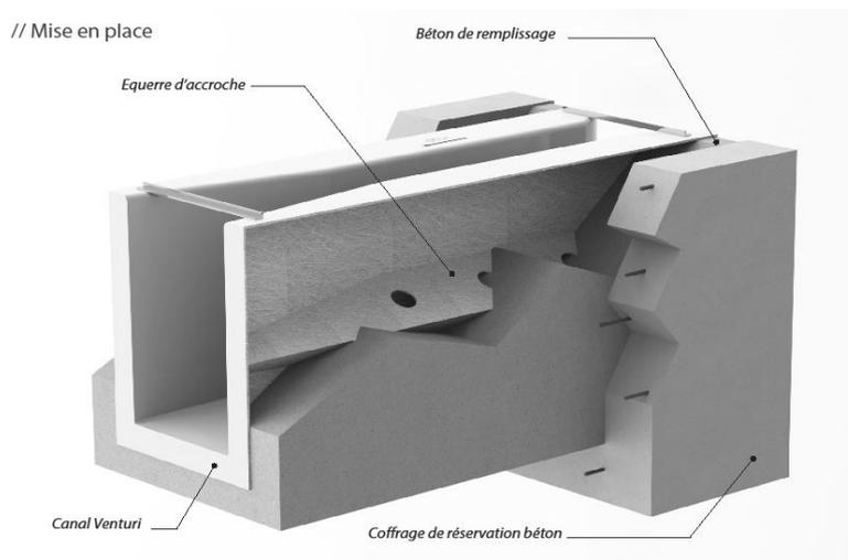
Prévoir un ouvrage d'accueil en béton afin d'intégrer le canal de niveau dans de bonnes conditions. Prévoir une réservation d'au moins **50 mm** de part et d'autre de la largeur et la hauteur hors tout du canal afin que le béton de remplissage s'intercale bien entre les bords supérieurs des canaux et le coffrage de réservation en béton.
