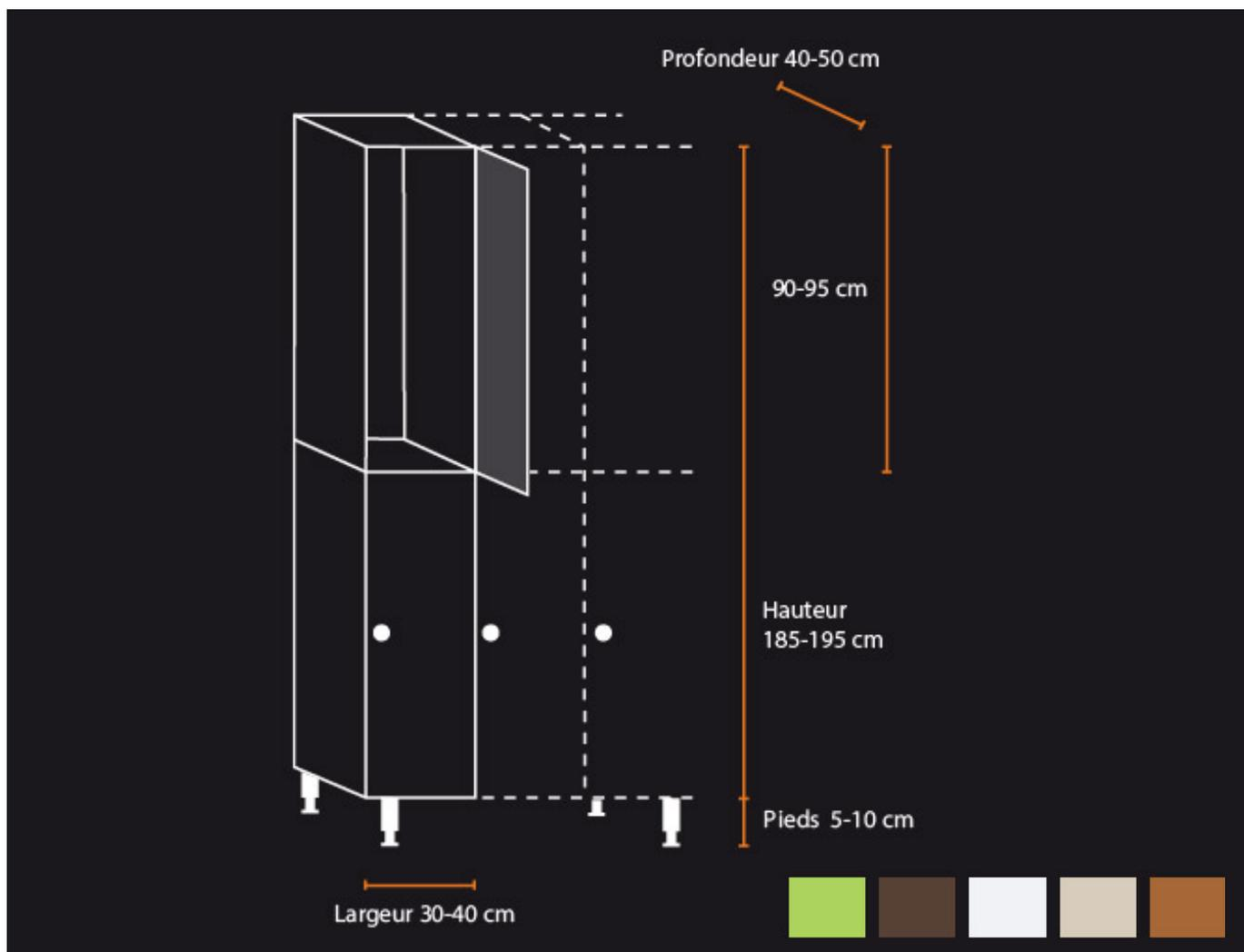
Structures et portes en médium MDF (Medium Density Fiberboard – panneaux de fibres de moyenne densité) ou en stratifié massif, avec limiteur d'ouverture de porte (inclus).
