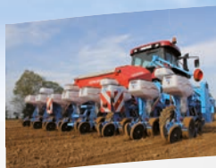
Semoir pneumatique polyvalent Monoshox NG Plus M à disques
