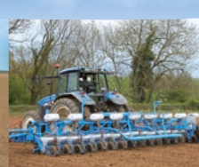
Semoir mécanique à betterave enrobée MECA V4
