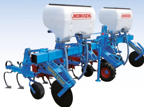
Bineuse rigide TIP 5" - 4 rangs à 75 cm d'inter-rang
