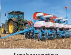
Semoir pneumatique spécial "semis simplifiés" Monoshox NX M à disques
