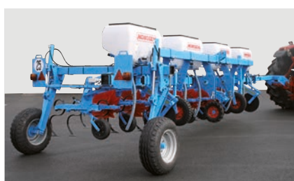
Bineuse rigide TIP 5" 8 rangs à 70 cm d'inter-rang au transport
