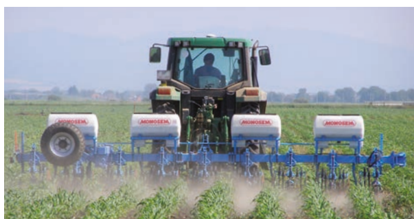
Bineuse rigide TIP 5" 8 rangs à 70 cm d'inter-rang au travail
