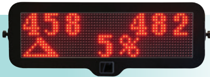
Resultats de l'épreuve (forces de freinage et déséquilibre) Test results (brake forces and imbalance) Resultados del test (fuerzas de frenado y diferencia entre ruedas)
