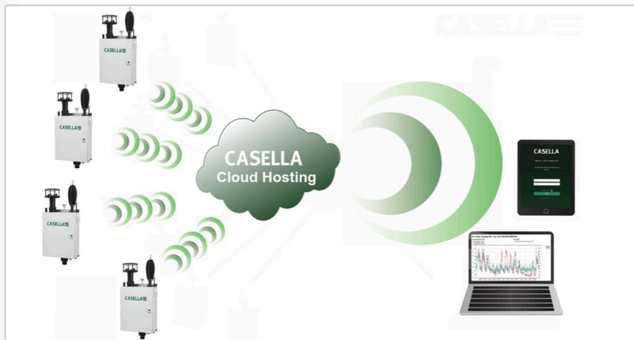
L'enregistreur de données mHUB avancé Guardian 2 et la connectivité au web permettant la transmission continue des données vers le cloud. Des alertes et des rapports d'état peuvent être acheminés sans problème vers votre dispositif portable.
