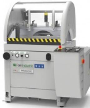
**Tronçonneuse à une tête ascendante Ø 550 mm avec positionnement manuel de l'axe vertical**
