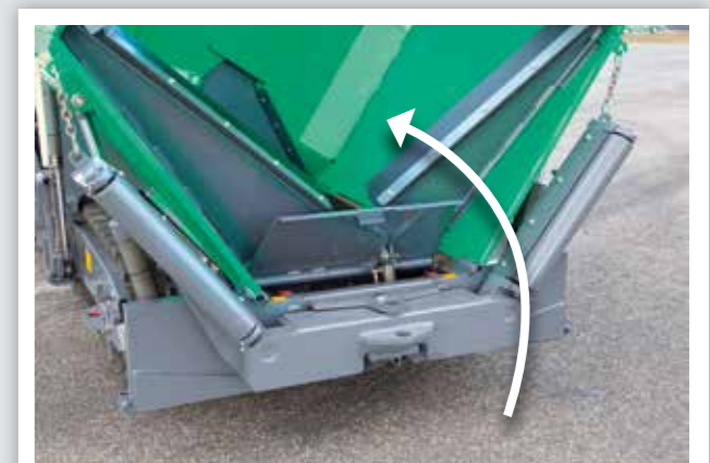
RELEVER LE CLAPET DE RECENTRAGE DE LA TRÉMIE
