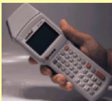
Les outils de saisie code barre : douchette avec ou sans fil, différents terminaux avec puits ou en liaison radio
