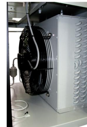
Conçue pour les environnements agressifs, cette option **protège les composants en cuivre et aluminium des sècheurs contre l'oxydation et la corrosion**. Un revêtement époxy spécial est appliqué sur les surfaces métalliques après traitement préalable, empêchant la formation d'acides liés à la condensation. Idéal pour prolonger la durée de vie du sécheur et éviter les pannes liées à la corrosion.
