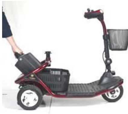
Schéma 14. Retirer le bloc batteries
