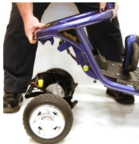
Schéma 18. Séparez le châssis avant
