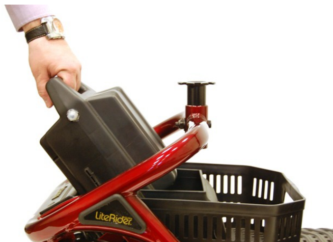
Schéma 21. Installation du bloc batteries
