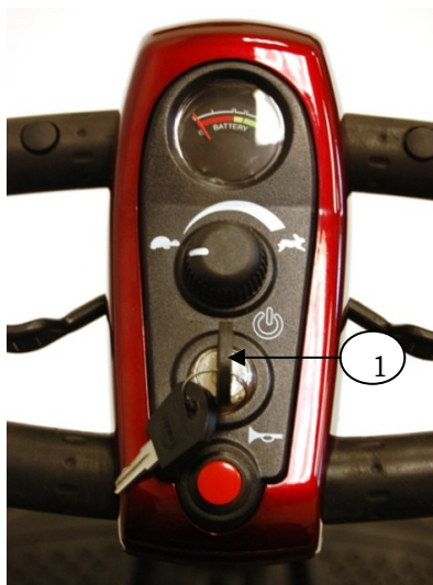
Schéma 11. contact coupé (Off)
