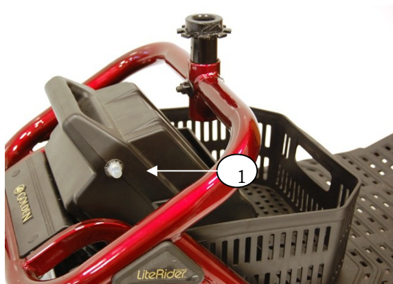
Schéma 27. Coupe Circuit Principal
