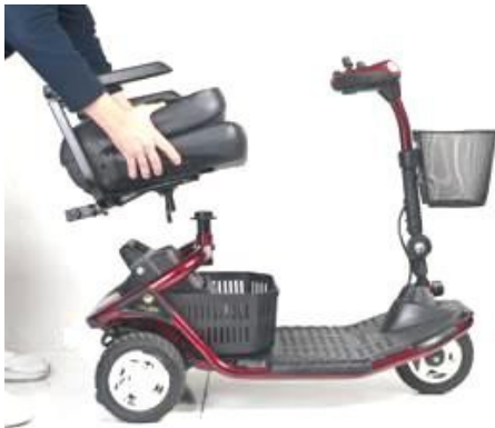
Schéma 13. Retirer le siège
