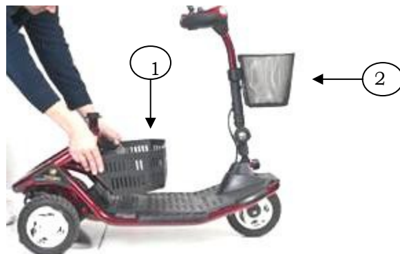
Schéma 15. Retirer les paniers
