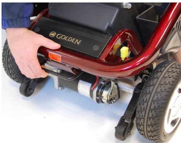
Schéma 17. Démontez le train arrière
