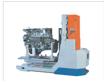
p.246 Mâts de levage pour véhicules FTS Mástiles de elevación para vehí- culos con sistema de transporte sin conductor
