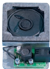
Module audio micro + haut-parleur (HP) dans cabine
