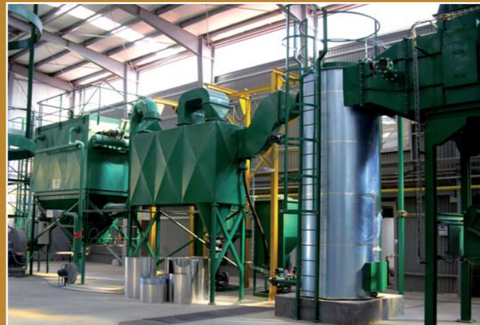
Exemples de neutralisation et filtration par voie sèche – conformes aux normes européennes. Examples of neutralisation and filtration by dry method – in conformity with European Norms.
