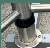
Rotor et boîtier de roulement inox
