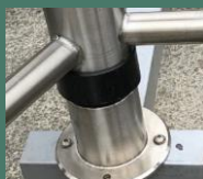
Rotor et boîtier de roulement inox
