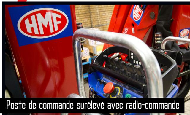
Poste de commande surélevé avec radio-commande
