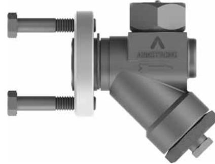
Le modèle CD-3300S d'Armstrong est un purgeur à trois canaux d'évacuation qui permettent un fonctionnement stable du disque et prolongent ainsi la durée de vie du purgeur.
