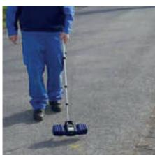
La localisation exacte par ondes radios permet de repérer à travers le béton et l'asphalte la tête de caméra. Cela permet de gagner beaucoup de temps et d'éviter ainsi la détérioration des constructions.
