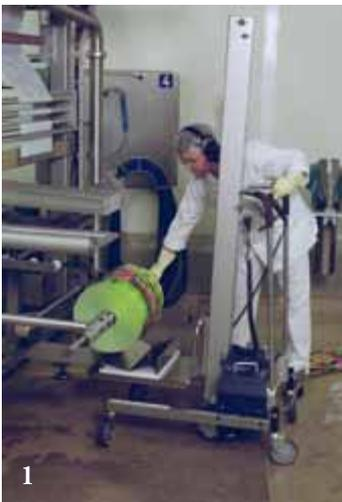
1. PRO120 équipé du V-block monté sur le plateau rotatif à 360°.
