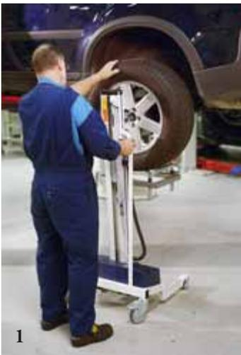
1. Exemple d'accessoire spécial pour aider à la manutention de charges lourdes comme le remplacement de roues (mandrin muni de billes de convoyage pour réduire la résistance au frottement).
