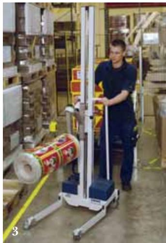
3-4. L'accessoire CoreGripper saisit la bobine par son mandrin et la tourne à 90° de position verticale à position horizontale. PRO70 (photo de gauche) PRO120 (photo de droite).
