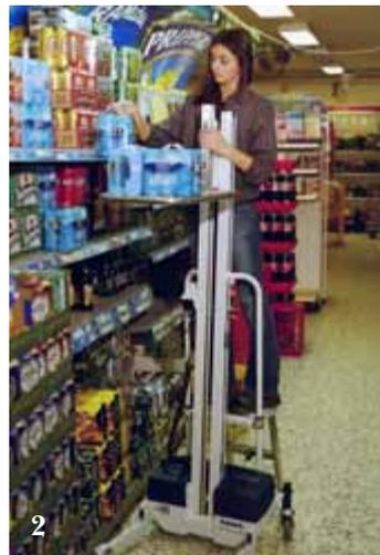
2. Adjonction d'une échelle repliable pour aider à la manutention en hauteur. (PRO70).
