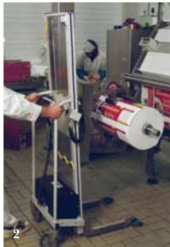
2. PRO120 équipé du système EasySqueeze en version à retournement électrique. Les bras saisissent et tournent la bobine de position verticale à position horizontale de présentation au chargement.
