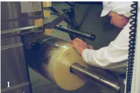
*1– 2. Le chargement de bobines sur une emballeuse est effectué sans effort et en toute sécurité avec un V-block (photo de droite) ou un mandrin (photo au dessus). Le V-block est amovible et permet ainsi l'utilisation du plateau pour d'autres types de manutentions entre deux chargements de bobines.*
