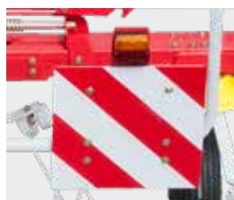
Panneaux de signalisation / éclairage
