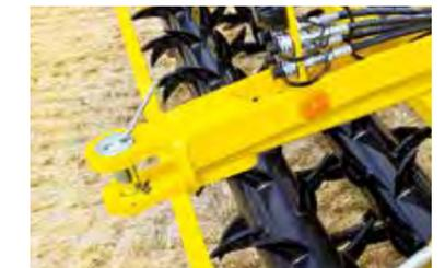
La machine TERRALAND TO est équipée d'un timon de traction à raccordement hydraulique et électrique. Ce timon vous permettra d'atteler d'autres outillages à la machine. Ces outillages seront utilisés pour finaliser l'opération d'ameublissement en profondeur. La machine peut ainsi être accouplée à un rouleau tracté CUTTERPACK ou PRESSPACK.
