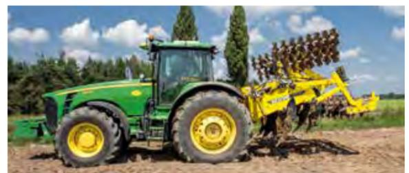
La section de disques Cutter se replie hydrauliquement au-dessus de la machine. Cette position permet de travailler avec ou sans section de disques Cutter arrière, par exemple lorsque vous devez faire face à d'importantes quantités de résidus végétaux.
