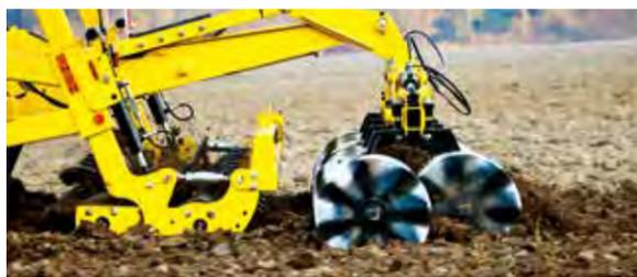
La section (batterie) de disques Cutter est formée de 2 rangées de disques en éventail, d'un diamètre de 520x5 mm. Les disques coupent, retournent la matière végétale et nivelent la surface en prévision du passage du semoir. Les disques Cutter s'interpénètrent, ce qui permet de garantir un effet autonettoyant lorsque les disques sont utilisés dans des conditions très humides.
