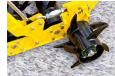
Les machines TERRALAND TN peuvent être équipées de rouleaux latéraux supplémentaires et repliables. Ces rouleaux empêchent la formation de mottes latérales. Le champ reste plat et ce, aussi sur les côtés de la machine.
