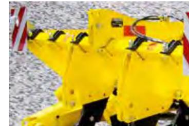
Les machines TERRALAND TN et TN\_PROFI sont attelées au véhicule tracteur par le biais d'un attelage à 3 points. La variante portée est très facile à manœuvrer, que ce soit au chaintre ou sur les voies de communication.
