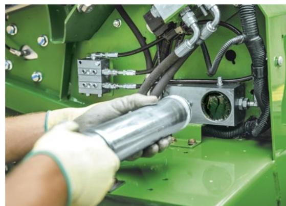
Un système de graissage automatique par cartouche est également disponible en option. Tous les points de graissage sont rassemblés, de série, dans un système centralisé.
