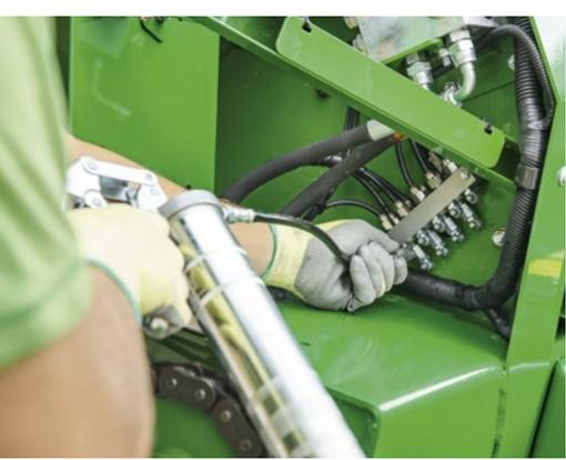
Tous les points de graissage ont été regroupés dans un système centralisé pour en faciliter l'accès. Le système de lubrification automatique des chaînes est de série.
