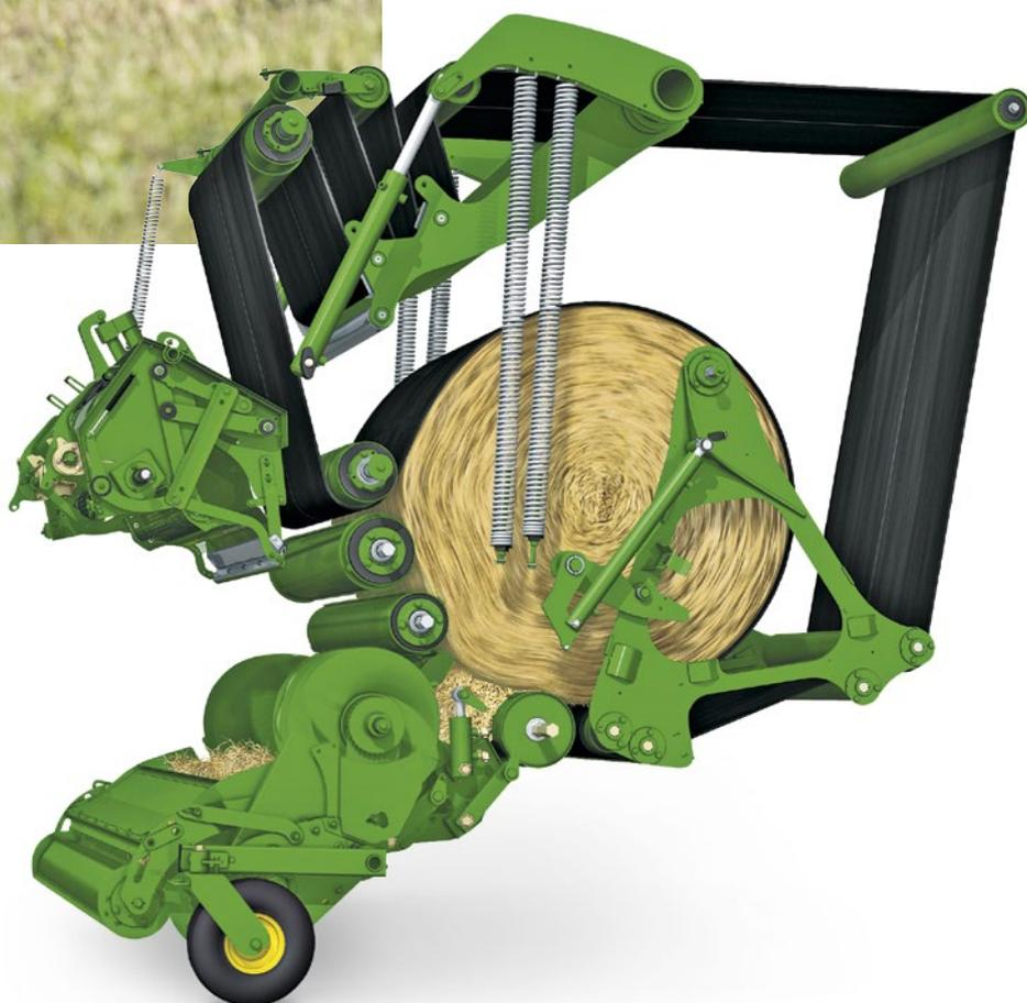
Deux larges courroies sans fin de 576 mm de large permettent la formation de balles ultra-denses et parfaites quelle que soit la culture. Un système de guidage des courroies très efficace assure un guidage irréprochable dans toutes les conditions. Trois rouleaux garantissent des balles parfaitement formées quel que soit le taux d'humidité de la récolte.
