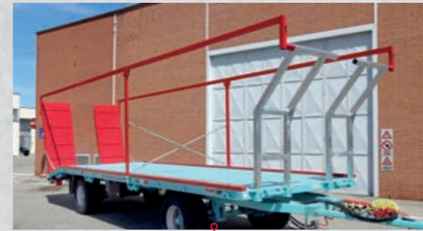
Tubular binding system with central pole and horizontal Système pour le transport de balles avec poteau central et tubulaire horizontal démontable
