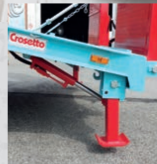
Stabilizing hydraulic stand jacks Béquilles hydrauliques de stabilité
