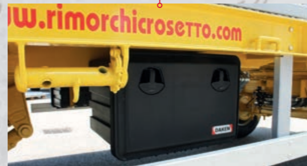
Lateral underrun protection Protection latérale
