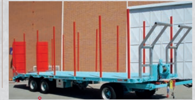
Bales binding system and lateral removable poles Système pour le transport de balles avec poteaux démontables
