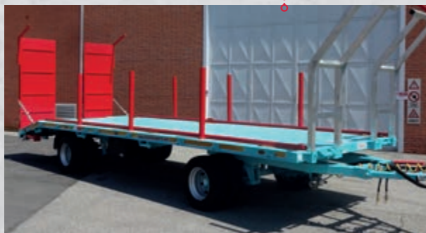
Timber binding removable poles Système pour bois avec poteaux latérales démontables
