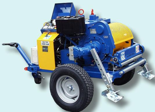
Treuil hydraulique conçu pour le tirage d'une câblette au cours des opérations de service telles que les montages, les régulations et la pose de câbles souterrains. Tirage direct sur le tambour. Un circuit hydraulique fermé permet la variation continue de la vitesse dans les deux sens de rotation à travers un seul levier de commande.
