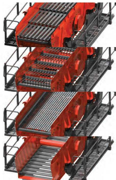
Possibilité de configuration avec grilles à barreaux, barres Bofar, plaques perforées et grilles en cascade.
