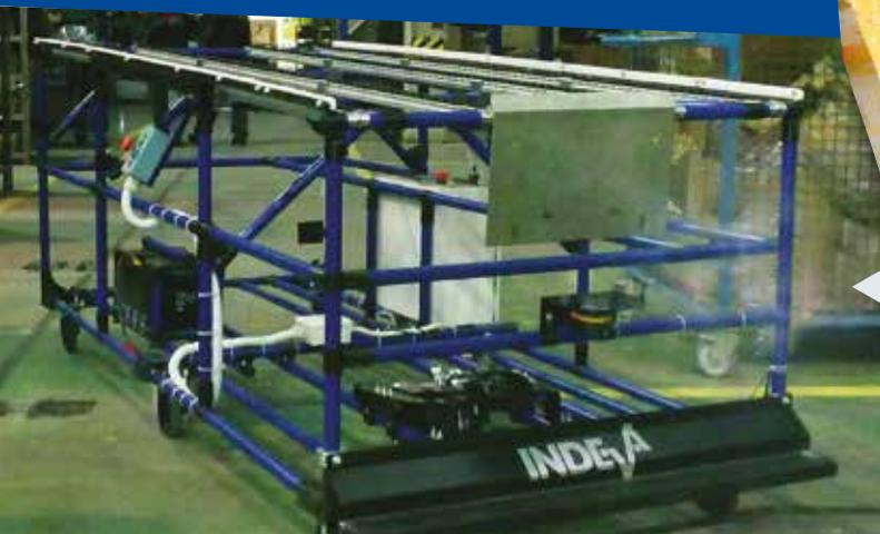
L'AGV gravitaire personnalisé Indeva est utilisé pour transporter des caisses et des petits contenants du magasin à la chaîne de montage et inversement.
