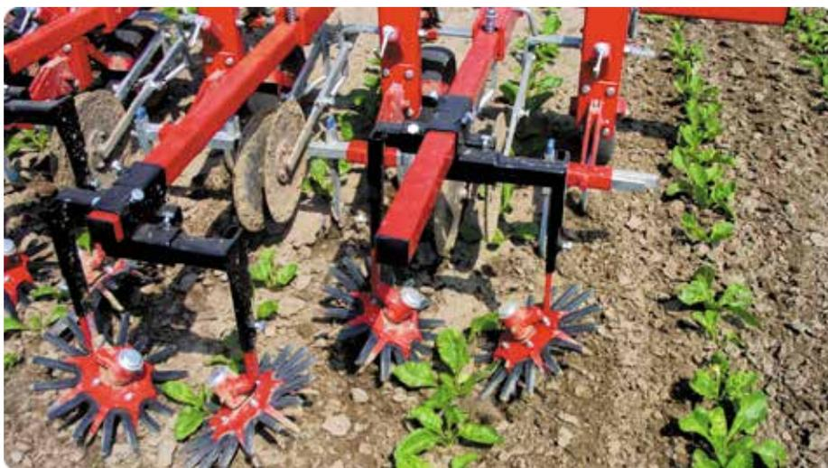
La sarclouse à doigts est composée d'une étoile avec des doigts en polyuréthane. Ces doigts fouillent entre les plantes cultivées et en frottant détruisent les adventices de plus petite taille. Dans des sols plus légers, l'étoile à doigts peut être remplacée par une étoile à brosse dans des cultures plus fragiles comme des légumes par exemple.
