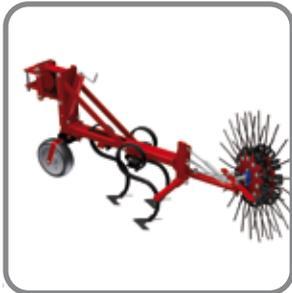
La roto-étrille se monte également sur l'élément TRS. La roto-étrille a été conçue pour le travail sur le rang de façon plus agressive. Elle est également adapté à des sols pierreux et/ou sols durs.
