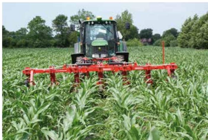
Avec l'élément TRS grand dégagement, nous augmentons la distance de la barre par rapport au sol. Combiné aux caches MS2 avec leurs caches réglables en largeur, cela donne de très bons résultats en traitement par bande et en protection de culture.
