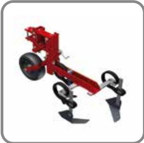
Ceci est un montage de socs sur des ressorts porte dents. Ce montage permet un très bon désherbage avec une protection des parties travaillantes et une meilleure pénétration. Afin de favoriser un flux plus important dans des sols légers le porte dent a été allongé.
