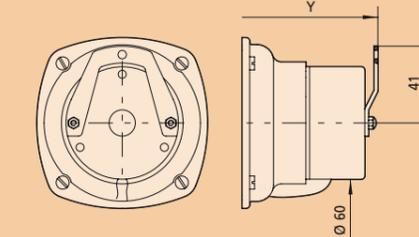
Limiteur de couple / Torque limiters
