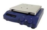
L'appareil est conçu pour le mélange ou l'agitation de liquides dans les écoles, laboratoires ou usines. L'agitateur peut être utilisé pour le mélange de liquides en bouteilles, flacons, éprouvettes avec des poids maximum de 2,5 kg. Cet appareil n'est pas adapté à une utilisation dans des zones résidentielles ou autres zones pouvant mettre en danger l'utilisateur ou l'instrument.
