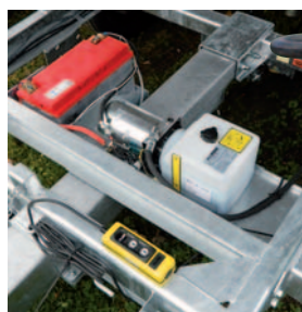
Pompe électrique avec batterie et boîtier de commande aimanté.
