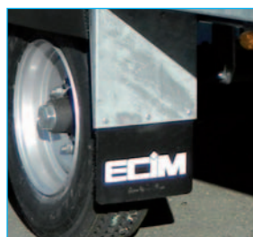
Les bavettes anti-projection captent l'eau projetée par les pneumatiques et en redirigent plus de 70% vers le sol, à l'abri des turbulences.
