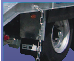
Les bavettes anti-projection captent l'eau projetée par les pneumatiques et en redirigent plus de 70% vers le sol, à l'abri des turbulences.
