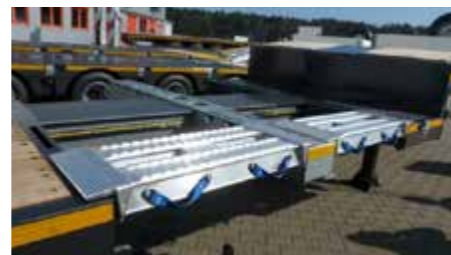
Eléments en ALU ± 1.160 x 420 x 120mm (pour une extension de 1.000mm) pour faire la jonction entre le plateau en position d'extension.
