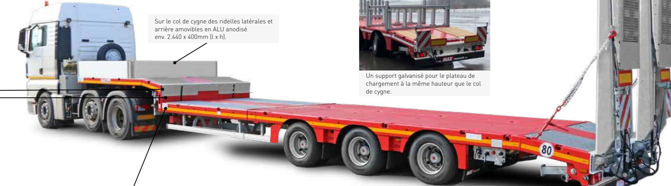
Eléments en ALU ± 1.160 x 420 x 120mm (pour une extension de 1.000mm) pour faire la jonction entre le plateau en position d'extension.
