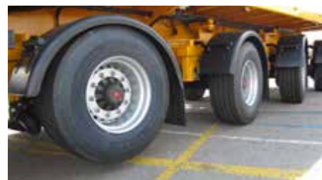
Premier essieu relevable (dépendamment de la charge) avec coussins d'air pour lever l'essieu.
