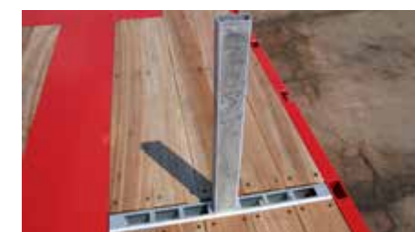
Rangées de boîtiers, installées dans le plateau de chargement.
