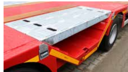
Recouvrement de fosse à roues.
