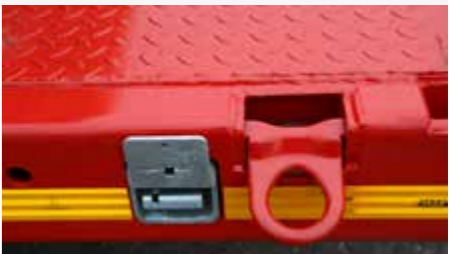
Anneau d'arrimage 10t rabattable vers l'extérieur.
