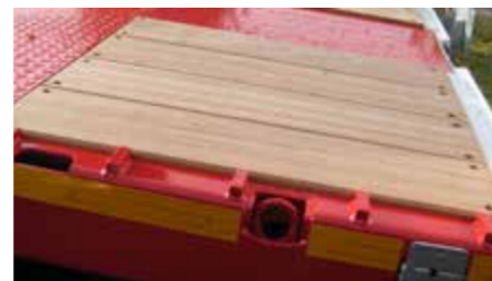
Fers carrés 20 x 20mm tous les 200mm sur le chanfrein du cadre extérieur du plateau de chargement.
