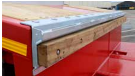
Profil en U avec protection pour permettre l'accrochage de rampes en ALU au col de cygne.
