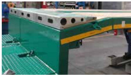
Cales de compensation galvanisées pour chanfrein avant 750 x 10° avec broches de fixation.
