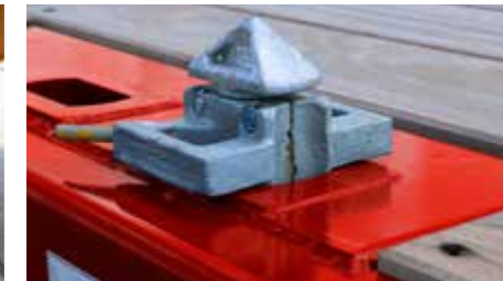
Pochettes conteneur WADER dans le plateau de chargement pour un conteneur 20", 2 x 20" ou 1 x 40". Fixations conteneurs WADER.
