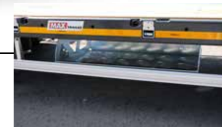
Un support galvanisé pour les bastaings d'élargissement en dessous du plateau de chargement .
