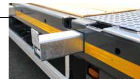
Elargisseurs galvanisés, extensibles d'env. 230mm par côté.
