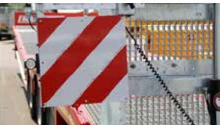
Au col de cygne et sur les rampes, à gauche et à droite, une fixation pour panneau de signalisation, inclus une prise.
