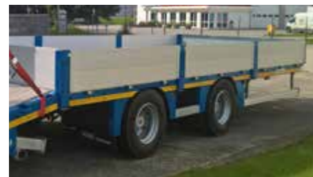
Ridelles rabattables en ALU, d'une hauteur de ± 400 mm.
