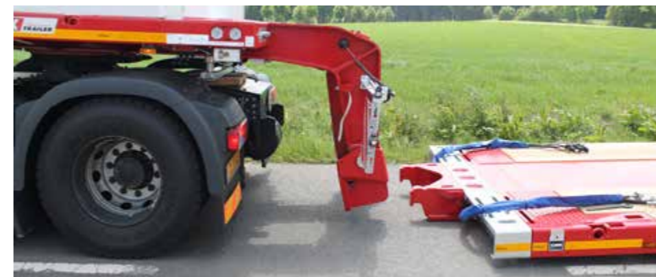
Elargisseurs galvanisés, extensibles d'env. 230mm par côté.
