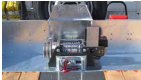
Un treuil électrique avec radiocommande (force de traction d'env. 5.400kg) inclus un câble métallique diamètre 9,5mm longueur 24m avec guidage pour le câble.
