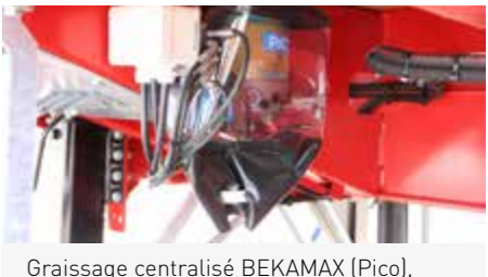
Graissage centralisé BEKAMAX (Pico), graisse normale NLGI-2 avec protection amovible autour de la pompe.
