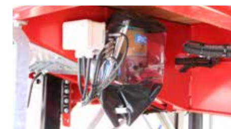
Graissage centralisé BEKAMAX (Pico) avec graisse normale NLGI-2 avec protection amovible autour de la pompe.
