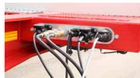
Raccord d'air au col de cygne avec pistolet à air.
