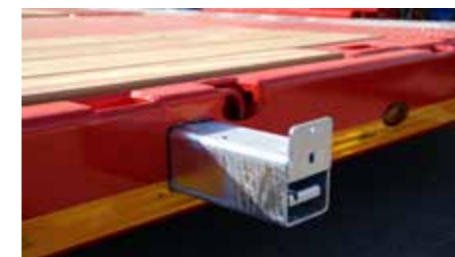
Elargisseurs galvanisés, extensibles d'env. 230mm par côté.
