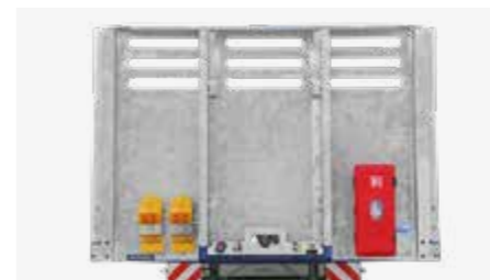
Une paroi avant, galvanisée, d'une hauteur d'env. 1.600mm.
