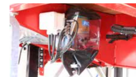
Graissage centralisé BEKAMAX (Pico) avec graisse normale NLGI-2 avec protection amovible autour de la pompe. (MAX210)
