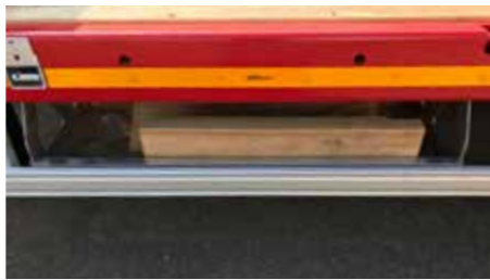
Un support galvanisé pour les bastaings d'élargissement à gauche et à droite en dessous du plateau de chargement.
