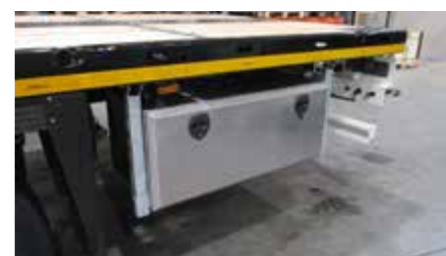
Une caisse à outils INOX en dessous du plateau de chargement 1.200 x 460 x 550mm.
