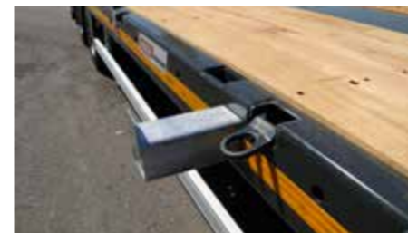
Elargisseurs galvanisés, extensibles d'env. 230mm par côté.
