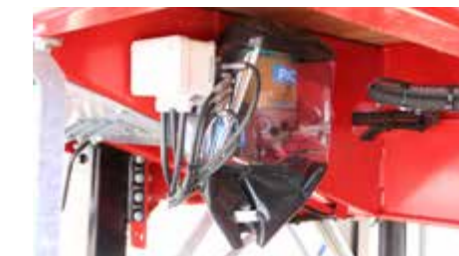
Graissage centralisé avec 2 pompes BEKAMAX (Pico) avec graisse normale NLGI-2 avec protection amovible autour de la pompe.
