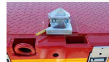
Boîtiers pour ranchers env. 100 x 50mm encastrées dans le cadre extérieur du plateau de chargement.
