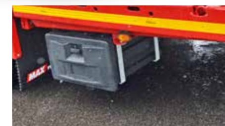
Une caisse à outils HDPE 620 x 360 x 610mm / 1.200 x 500 x 480mm.
