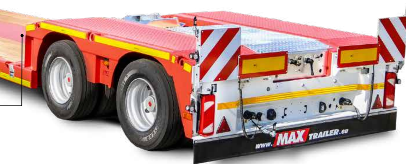
Rampes Alu VFR 120 pour passer au-dessus des crochets du plateau extra-surbaissé.
