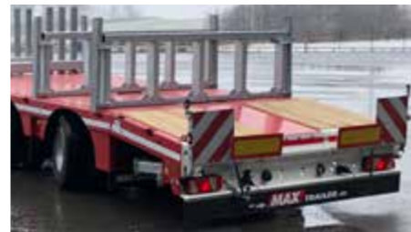
Un support galvanisé pour le plateau de chargement à la même hauteur que le col de cygne.
