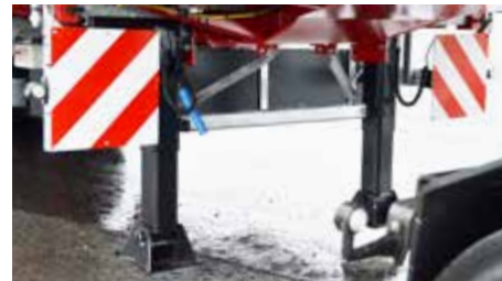
Panneaux de signalisation env. 423 x 423mm extensibles de \pm 400mm avec 1 feu de position LED.
