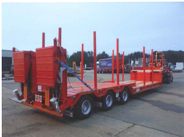
Semi-remorque mixte porte engins forestier / transport de bois ronds
