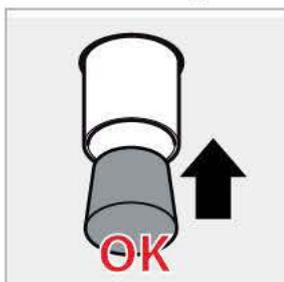
S'il n'est pas possible de raccorder de manière permanente le four BAKERTOP MIND.Maps à un système d'évacuation, il est nécessaire de fermer le terminal à l'aide du bouchon conique fourni avec le « Starter kit ». Avec le terminal bouché, n'utilisez jamais les programmes de lavage et ne lavez pas la chambre avec de grandes quantités d'eau à cause du danger d'inondation.
