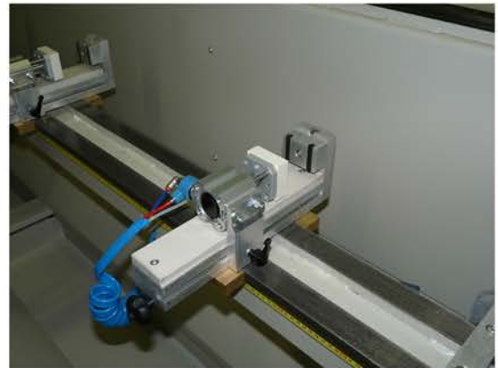
4 étaux pneumatiques sur rails
