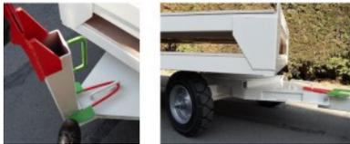
**Équipements de la remorque** Plateaux en contreplaqué ep=15mm, 4 roulettes en caoutchouc : 2 montées sur train fixe et 2 sur train pivotant.
