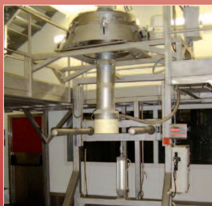
Conditionnement de big bags avec tamisage de sécurité
