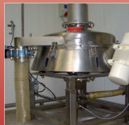
Tamis vibrant implanté en ligne sur un transfert pneumatique
