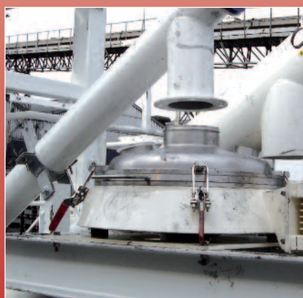
Tamis vibrant alimenté par vis de transfert sur du noir de carbone
