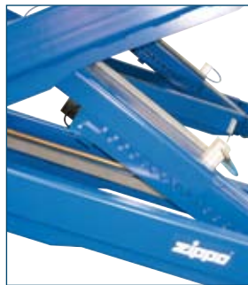
Absetzklinken zur Achsvermessung und als Sicherheitsfeature
