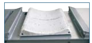
Integrierter pneumatischer Achsspieldetektor Integrated pneumatic axle play detector
