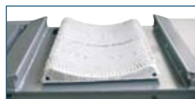
Integrierter pneumatischer Achsspieldetektor Integrated pneumatic axle play detector
