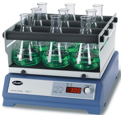
Silencieux et robustes ces appareils à vitesse variable donnent à vos échantillons un mouvement orbital régulier et de faible amplitude.
