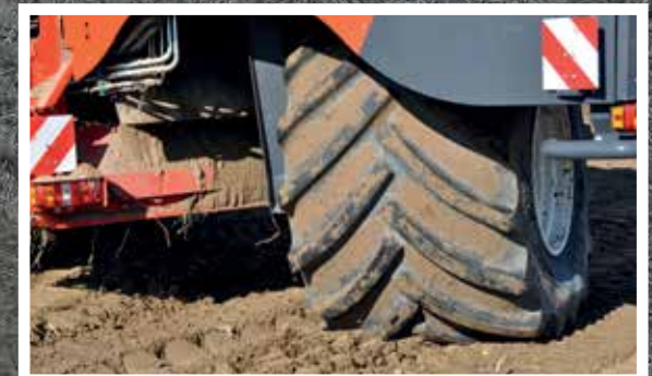
Roue arrière super large (1250/50 R32) pression de pneu à 1,4 bars.
