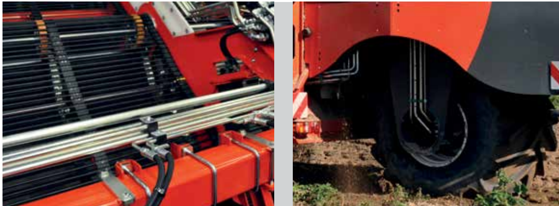
Utilisation maximale de conduits = aucun frottement entre les tuyaux
