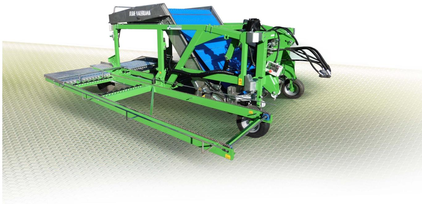
Récolteuse trainée par tracteur pour la récolter de mâche, avec un système automatisé pour charger et décharger les bins au côté de la machine. Tapis semi-verticale avec des tiges pour garantir le retour parfait du produit, sans le ruiner. Capteurs électrohydrauliques proportionnels avec hauteur de coupe réglable, contrôlés par l'opérateur ou, sur demande, de la cabine du tracteur. Chassis a treillis pour rendre la machine solide.
