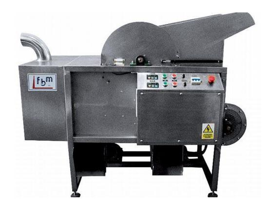
La broyeuse décortiqueuse **FBM** permet de séparer la peau des fèves torréfiées après son passage en pré-broyeuse et de préparer un grué de bonne qualité. D'une capacité adaptée à une production moyenne, elle est l'outil idéal du chocolatier qui veut développer une fabrication « de la fève à la tablette ».
