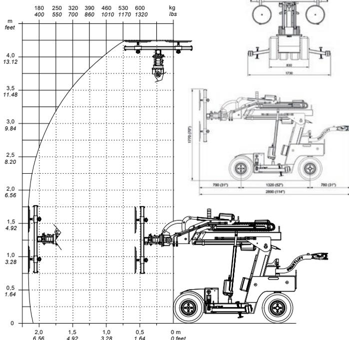
Modèle Outdoor hauteur de pose étendue 4 200 mm avec deux extensions électriques et rotation du palonnier électrique.
