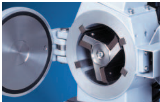
Aperçu de la zone de broyage du SM 100 (rotor à découpe parallèle avec 3 couteaux et 4 contrecouteaux dans la zone de broyage)
