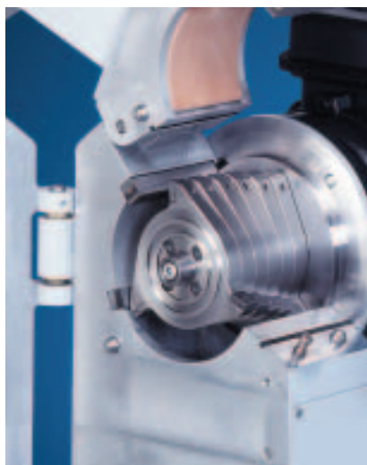
Aperçu de la zone de broyage du SM 2000 (avec rotor-6-disques universel pour une coupe tangentielle très énergique)
