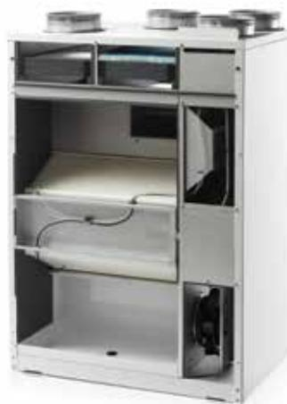
Les condensats produits par l'échangeur de chaleur sont évacués via l'évacuation des condensats. Cette évacuation doit être dotée d'un siphon et protégée contre le gel si l'appareil est installé à l'extérieur de la zone isolée.
