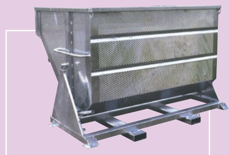
Benne en tôle perforée pour égouttage
