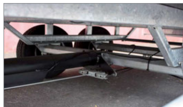
Chassis soudé pour une meilleure résistance, double essieu auto-freiné
