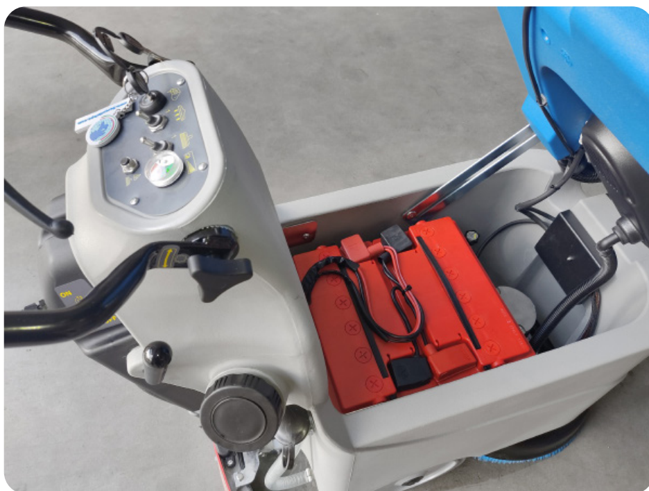
batterie al gel o acido con una grande autonomia gel or acid batteries with great autonomy
