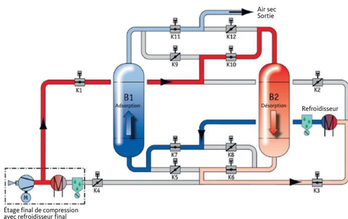
Le procédé complet est réalisé sous la pression de service aussi bien dans la phase d'adsorption que dans la phase de désorption et de refroidissement. De cette manière, la chaleur dégagée lors de la compression est exploitée pour la désorption, avec une production de l'air comprimé à l'aide de compresseurs non lubrifiés.
