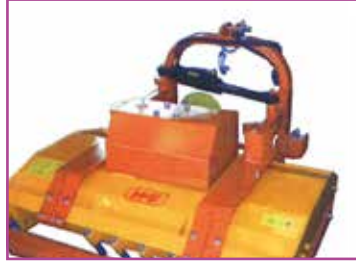
Déport par parallélogramme (D.D.M.)
